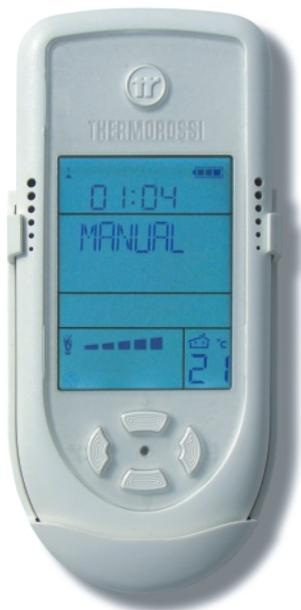
Sistema THERMOCOMFORT: regola il tuo comfort ottimale posizionando il radiocomando nella zona centrale della casa. La temperatura dell'ambiente è rilevata lontano dalla fonte di calore attraverso il termostato integrato nel radiocomando. Imposta i tuoi gradi ideali e con l'avvicinarsi alla temperatura desiderata il radiocomando modula la potenza della stufa fino a posizionarla al minimo. Solo il radiocomando Thermorossi riduce i consumi e garantisce, sempre, l'ambiente ideale.
